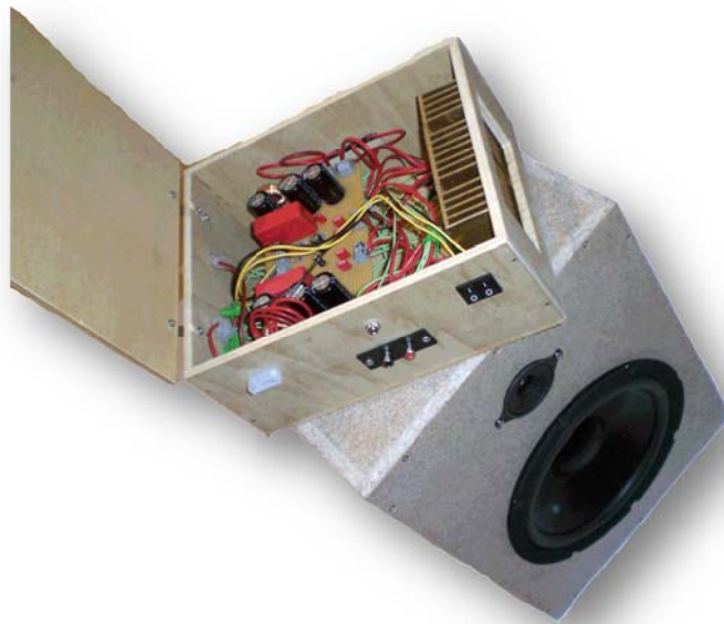
Abb. 10: 12V Verstärker und 2-Wege-Lautsprecher
